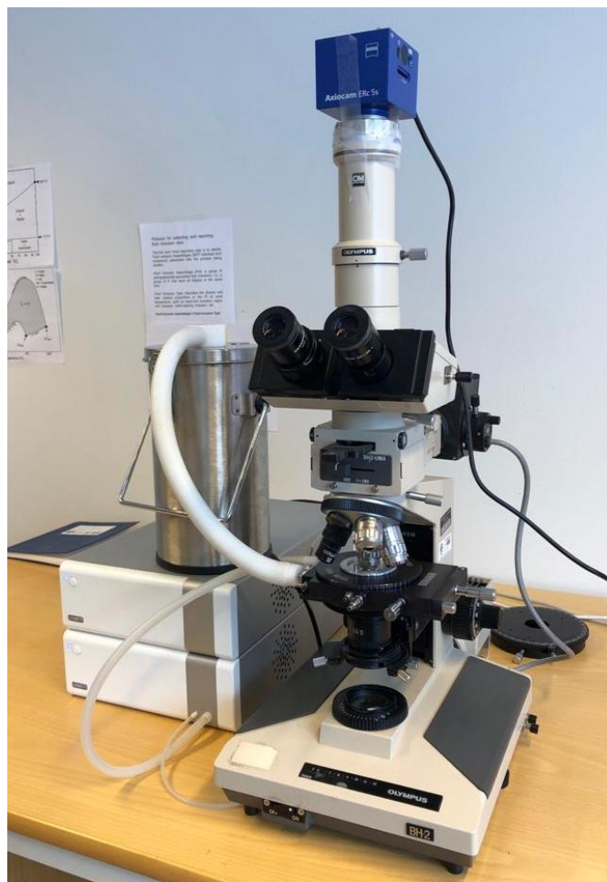
Slika 12. Mikroskop s komoricom (Linkam THMS 600) za mikrotermometrijska mjerenja korišten tijekom izrade rada
