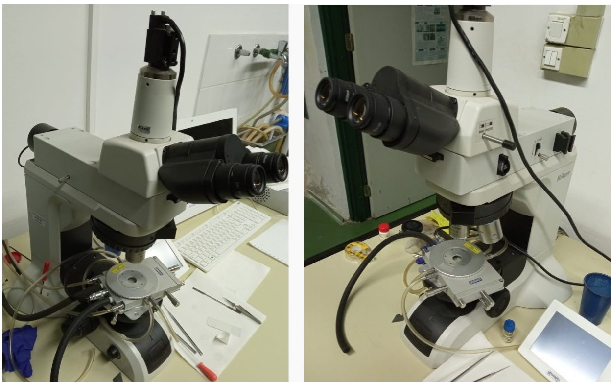
Slika 9. Mikroskop sa grijaćom pločom i komorom za hlađenje u laboratoriju za Mikrostrukturalna istraživanja na Prirodoslovno-matematičkom fakultetu u Zagrebu
