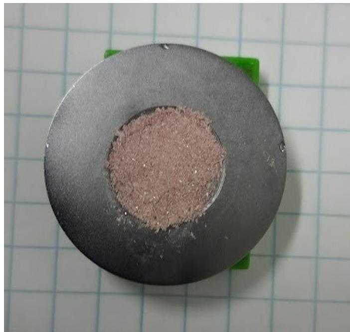
Slika 17. Uzorak NEW TTC-a pripremljen za mjerjenje u difraktometru
