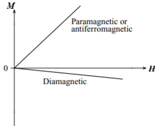
Slika 2.4: Krivulja magnetizacije za dijamagnete, paramagnete i antiferomagnete [5]
