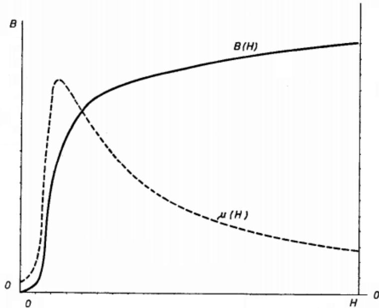
Slika 2.3: Krivulja magnetiziranja i magnetska permeabilnost za željezo [9]
