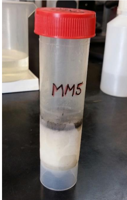
Slika 14. Zaleđeni sadržaj jedne od kiveta. Na vrhu kivete se nalazi laka frakcija, a na dnu teška frakcija.
