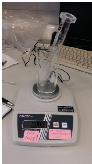
Slika 20. Laboratorijska vaga s 3 decimale. Proizvođač KERN & Sohn GmbH, model EMB 200-3.
