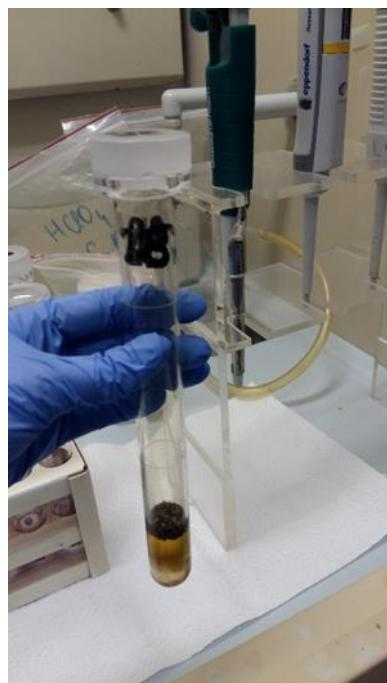
Slika 21. Kvarcna kiveta s uzorkom mikroplastike te 6 ml s.p.  $HNO_3$  i 4 ml s.p.  $HClO_4$
