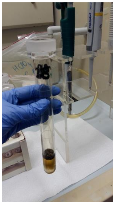
Slika 21. Kvarcna kiveta s uzorkom mikroplastike te 6 ml s.p. HNO 3 i 4 ml s.p. HClO 4
