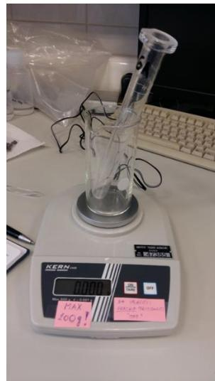
Slika 20. Laboratorijska vaga s 3 decimalne. Proizvođač KERN & Sohn GmbH, model EMB 200-3.
