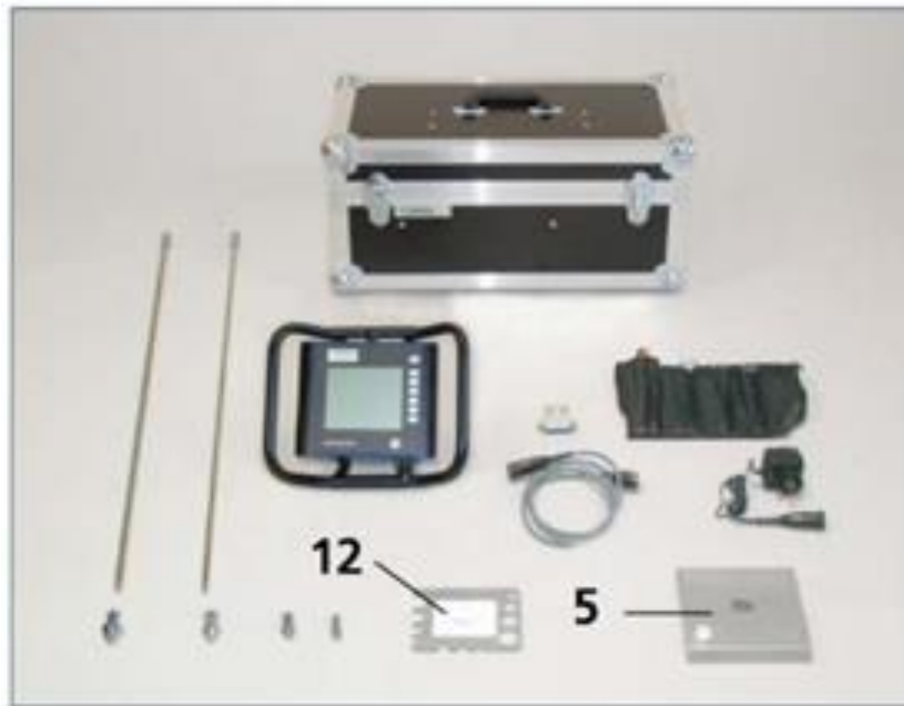
Sl. 41. Digitalni konusni penetrometar s popratnom opremom
