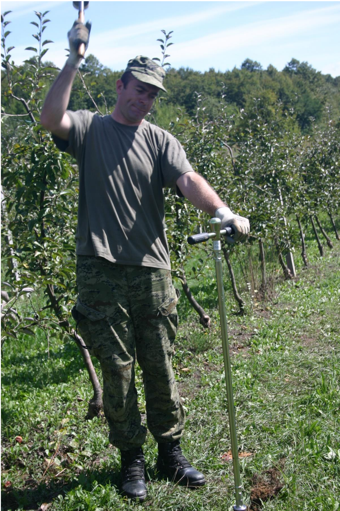
Sl. 34. Uzorkovanje tla uzorkivačem „Foil sampler“ na lokaciji Lapovci
