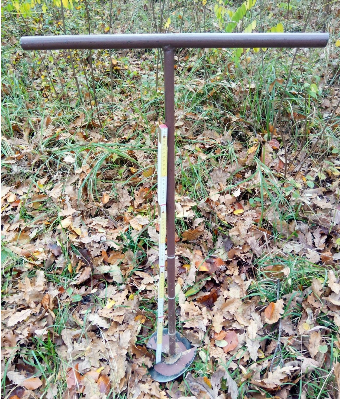
Sl. 45. Svrđlo za bušenje tla
