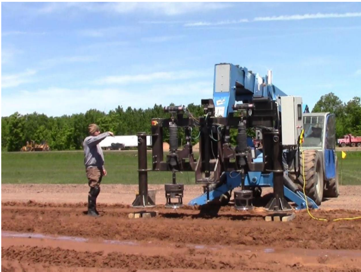
Sl. 17. Terensko mjerenje bevametrom montiranim na buldožer
