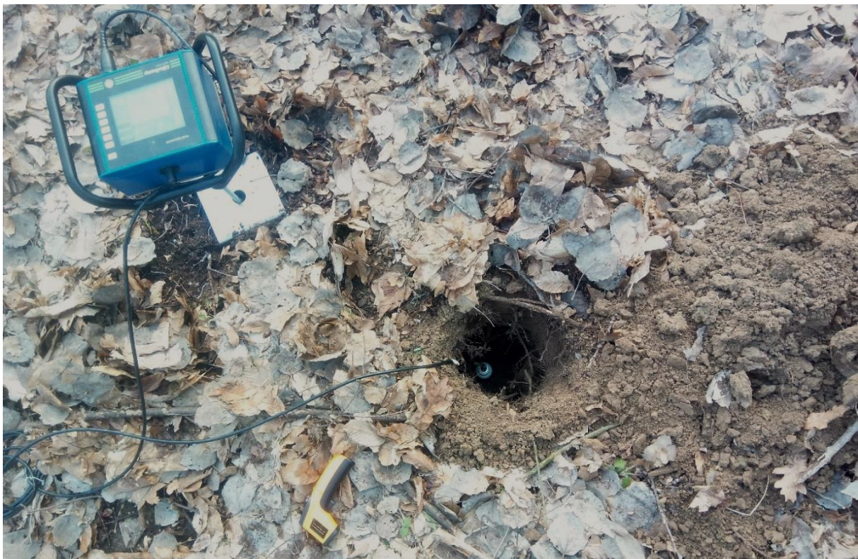
Sl. 42. In situ mjerenje digitalnim konusnim penetrometrom
