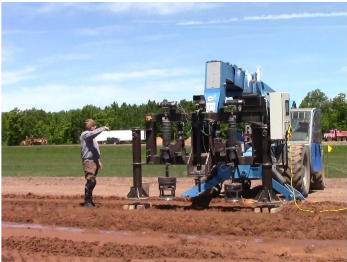
**Sl. 17. Terensko mjerenje bevametrom montiranim na buldožer**
