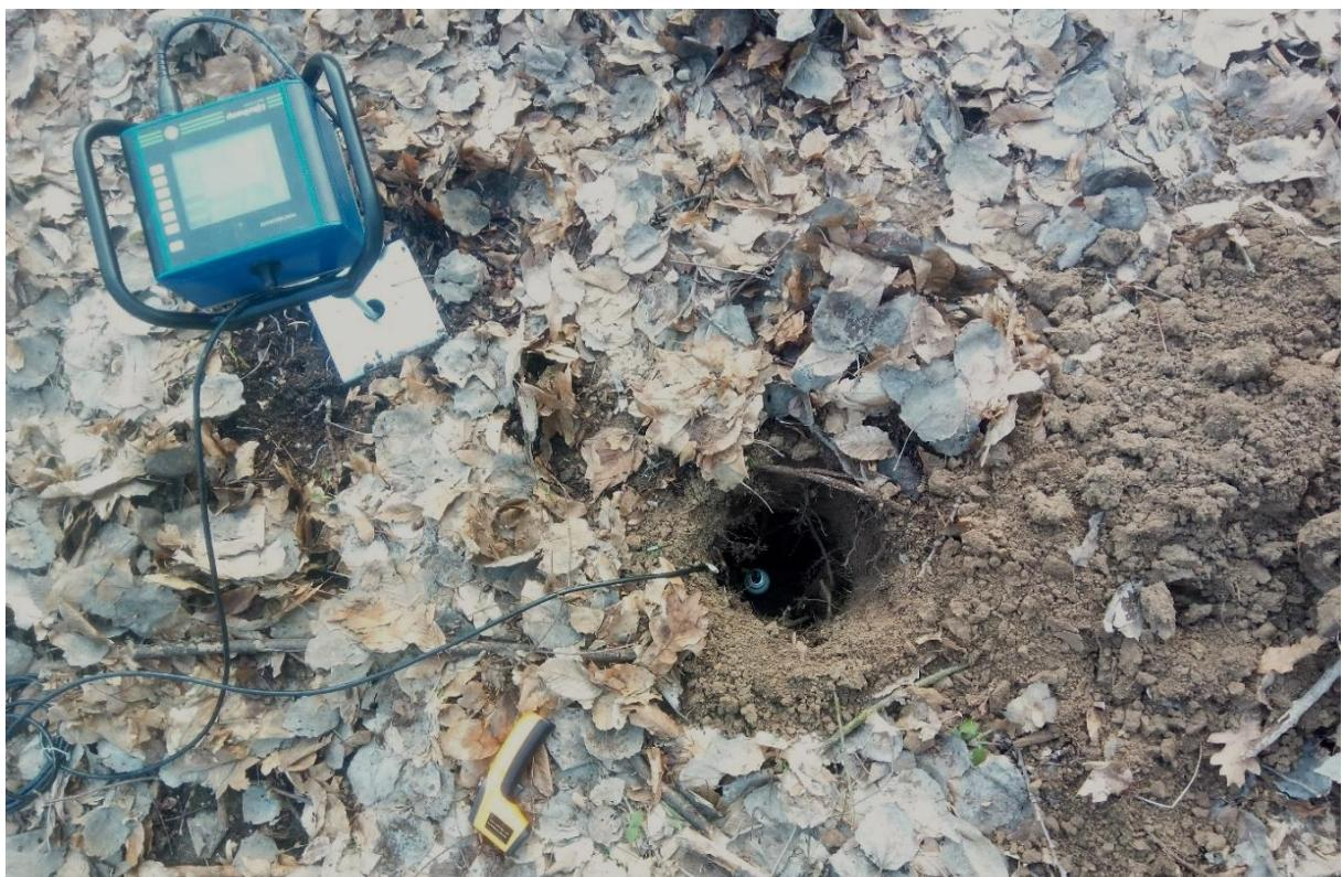
Sl. 42. *In situ* mjerjenje digitalnim konusnim penetrometrom
