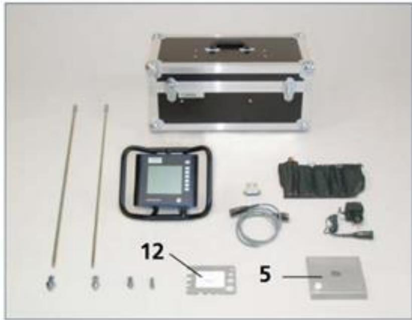
Sl. 41. Digitalni konusni penetrometar s popratnom opremom
