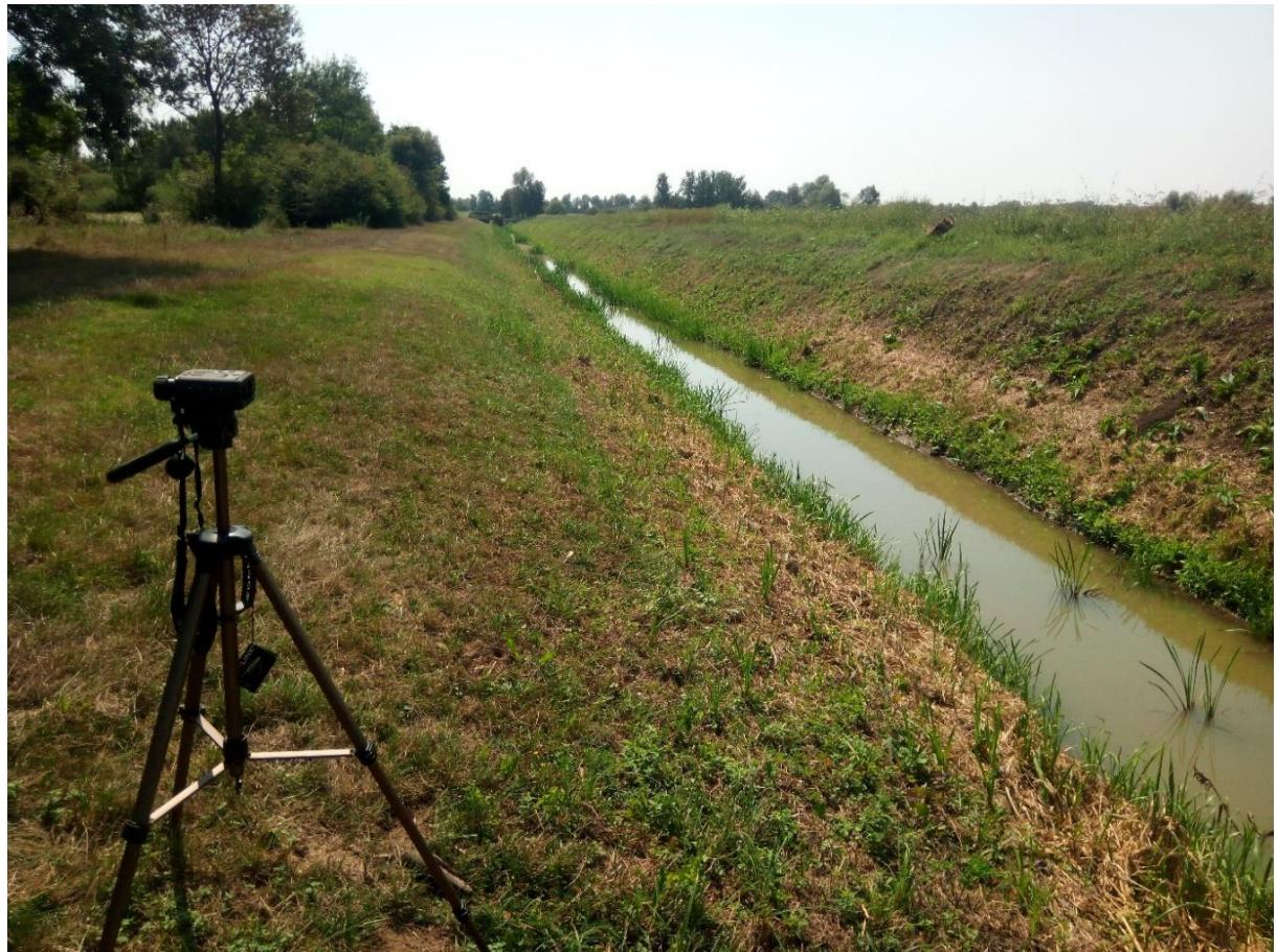
**Sl. 50. Terensko mjerjenje poprečnog profila vodotoka uređajem TruPulse 360°R
