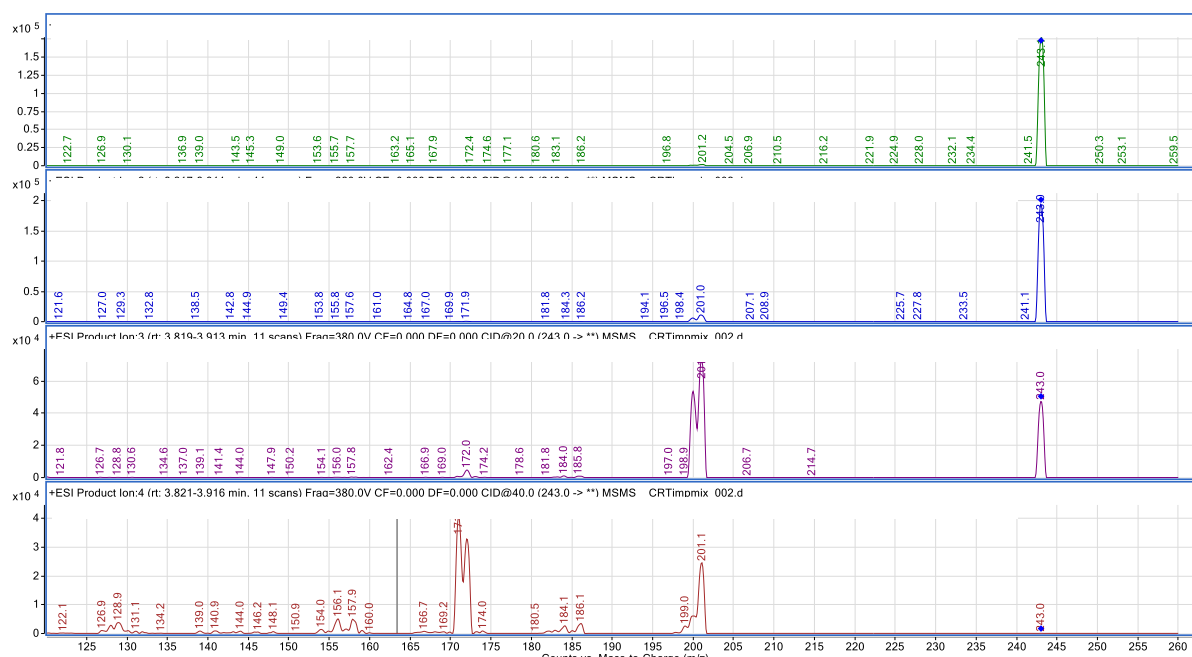
Slika D1. Spektar MS/MS onečišćenja PGI 1 pri četiri različite kolizijske energije.
