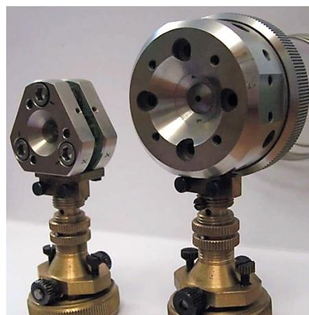
Slika 25. Dijamantne ćelije montirane na goniometarsku glavu: Merrill-Bassettova dijamantna ćelija s čeličnim pločama (Merrill i Bassett, 1974.) (lijevo) i DAC s plinskom membranom i berilijevim pločama (desno).<sup>153</sup>
