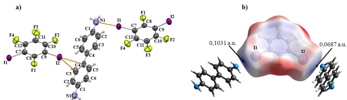
Slika 38. a) ORTEP prikaz jedinice kokristala (bnzd)(13tfib) 2 . Svi atomi su prikazani elipsoidima pomaka s 50% vjerojatnošću. Atomi vodika su prikazani kuglicama veličine 0,15 Å. Halogenske veze I\cdots N i I\cdots \pi prikazane su narančastim isprekidanim crtama. b) Elektrostatski potencijal mapiran na Hirshfeldovu plohu na molekuli 13tfib . Plava boja označava pozitivni, a crvena boja negativni elektrostatski potencijal
