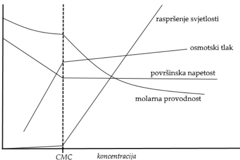
Slika 5. Shematski prikaz nekih svojstava (raspršenje svjetlosti,  $\tau$ , površinska napetost,  $\eta$  i molarna provodnost,  $\Lambda$ , osmotski tlak,  $\Pi$ ) u ovisnosti o koncentraciji površinski aktivne tvari. Treba uočiti značajnu promjenu pri kritičnoj micelizacijskoj koncentraciji (CMC).<sup>6</sup>
