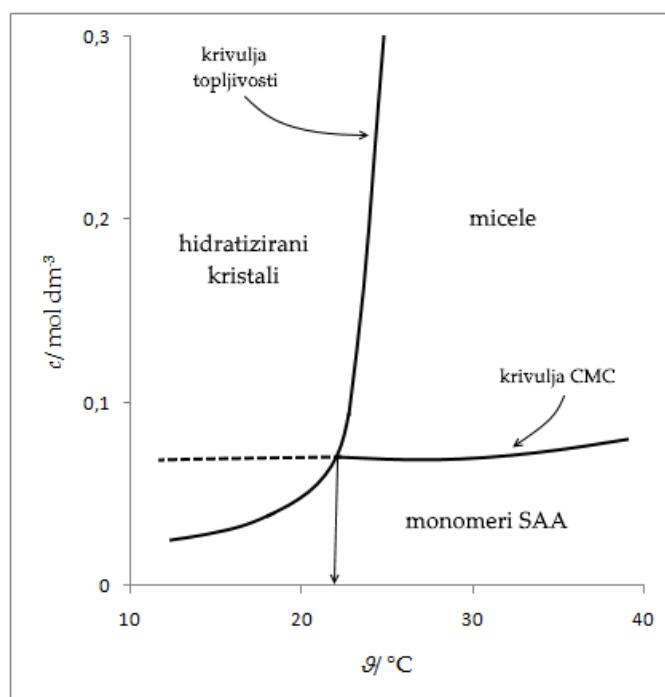
Slika 4. Shematski prikaz krivulje topljivosti tipične ionske površinski aktivne tvari. Iznad  $T_K$  topljivost se naglo povećava, što upućuje na bolju topljivost površinski aktivnih tvari u otopinama u kojima postoji mogućnost nastanka micela.<sup>3</sup>
