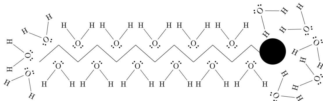
Slika 2. Shematski prikaz molekule površinski aktivne tvari u vodi. Hidrofoban rep je „hidratiziran“ strukturom nalik ledu, dok je hidrofilna glava hidratizirana na uobičajen način.<sup>1,2</sup>
