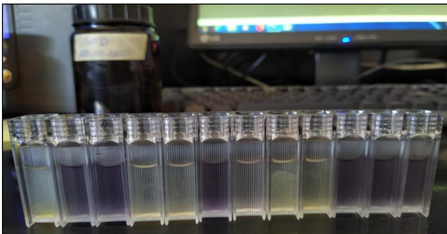
Slika 12. Plavo obojenje u kivetama zbog prisutnosti netopivog formazana
