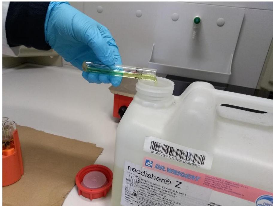
Slika 17. Odrijevanje supernatanta nakon prve centrifuge u kanister s otpadnom klorovodičnom kiselinom
