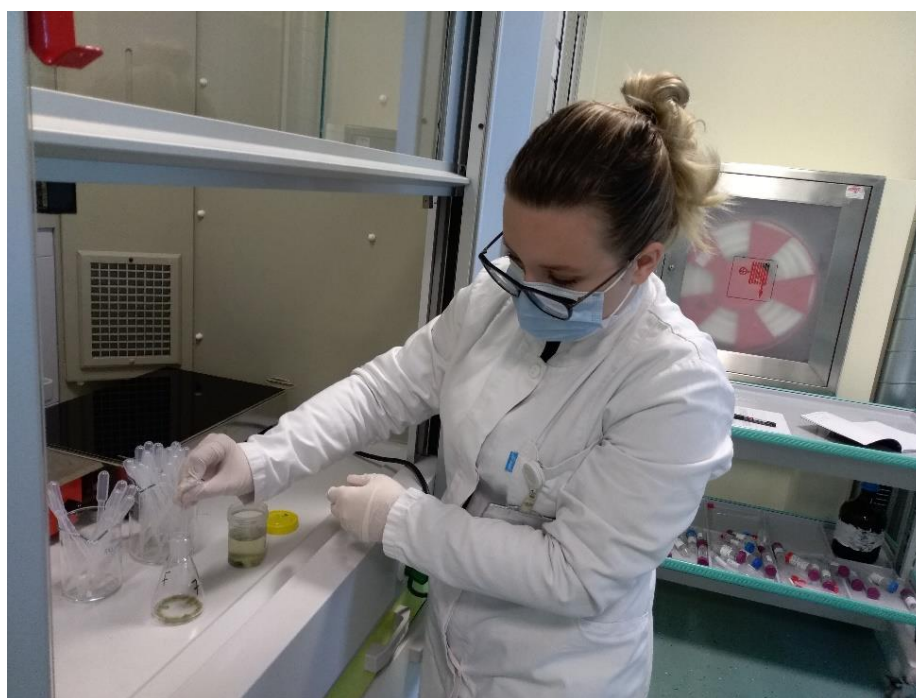
Slika 14. Premještanje 3 mL uzorka kapalicom iz čaše u Erlenmeyerovu tikvicu (autor: Lucija Kanjer)
