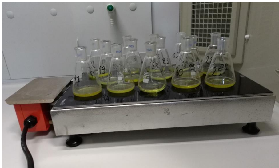
Slika 16. Promjena boje u tikvicama s uzorcima nakon dodatka 37 %-tne otopine klorovodične kiseline i kuhanja na 150 °C
