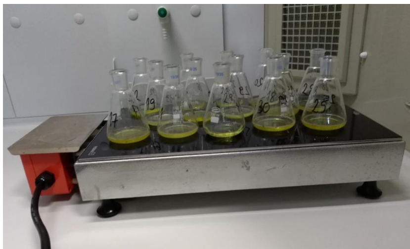
Slika 14. Promjena boje u tikvicama s uzorcima nakon dodatka 37 %-tne otopine klorovodične kiseline i kuhanja na 150 °C
