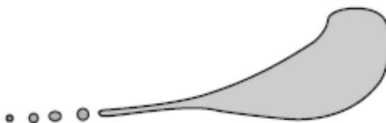
Slika 3. Dijeljenje kapljice raspadom mlaza. 4
