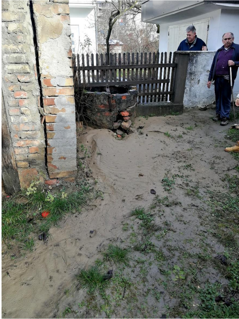
Slika 4. Nanos sedimenta izbačenog iz bunara likvefakcijom uslijed petrinjskog potresa (29.12.2020., M6,2). Na lokaciji je prikupljen uzorak S66_1.
