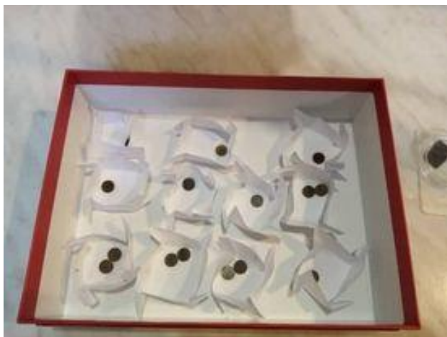
Slika 3. Pripremljene tablete uzoraka za analizu.
