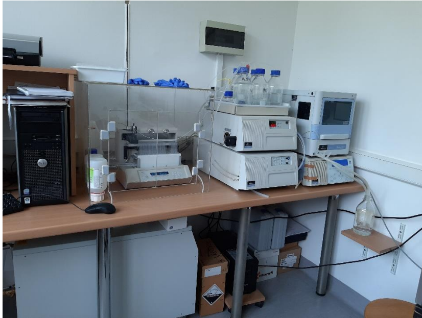
Slika 9. Sustav visokodjelotvorne tekućinske kromatografije uz isključenje molekula po veličini (SE-HPLC sustav).
