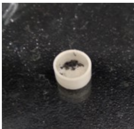
Slika 29. Crni prah \text{CuO} nakon termogravimetrijske analize [\text{Cu}_2(\text{L}^1)_2] .
