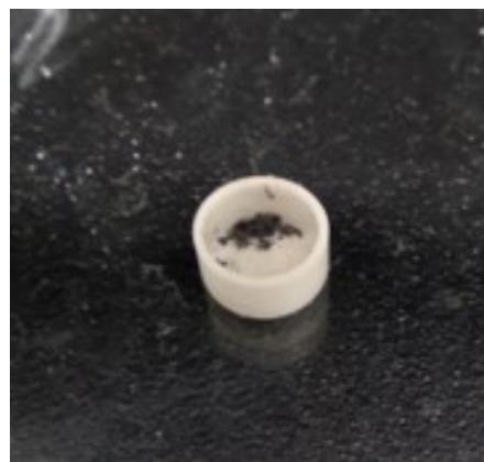
Slika 29. Crni prah CuO nakon termogravimetrijske analize  $[Cu_2(L^1)_2]$ .
