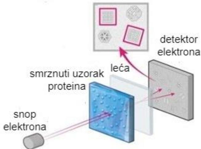
Slika 4. Shematski prikaz snimanja uzorka u krio-EM pri temperaturi od  $-180^{\circ}\text{C}$ . Snop elektrona prolazi kroz smrznutu mrežicu s uzorkom, pri čemu se elektroni reflektiraju ili prolaze kroz uzorak do leće koja ih usmjerava na detektor elektrona koji bilježi njihov signal te na taj način nastaje 2D slika uzorka. Pomicanjem izvora elektrona oko uzorka tvori se više
