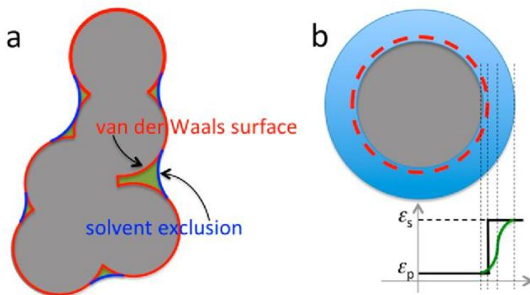
Slika 1. (a) Prikaz dvije dielektrične granice: plavo označava SE, a crveno vdW granicu, zelenom bojom je osjenčano područje nedostupno sfernoj probi (otapalu) u SE protokolu. (b) “Smoothed vdW“ površina, ili izglađena vdW površina, četiri vertikalne isprekidane linije označavaju redom početak dielektričnog prijelaza, pravu površinu atoma, srednju točku i krajnju točku dielektričnog prijelaza. Preuzeto iz izvora Zhou et al.<sup>1</sup>
